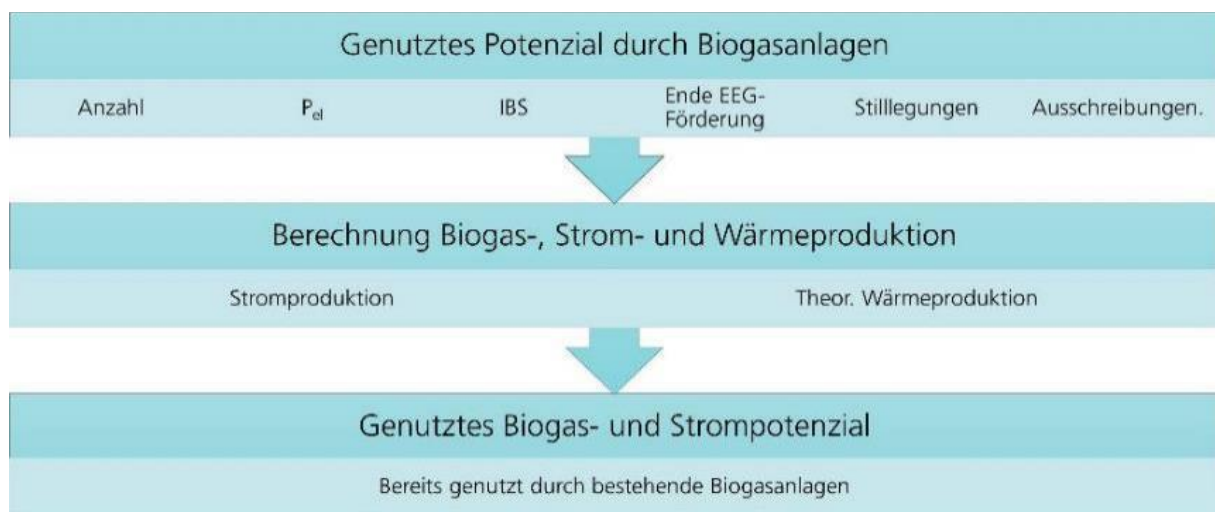
Abbildung 5-4: Untergeordneter Algorithmus zur Berechnung des bereits durch Biogasanlagen genutzten Potenzials
