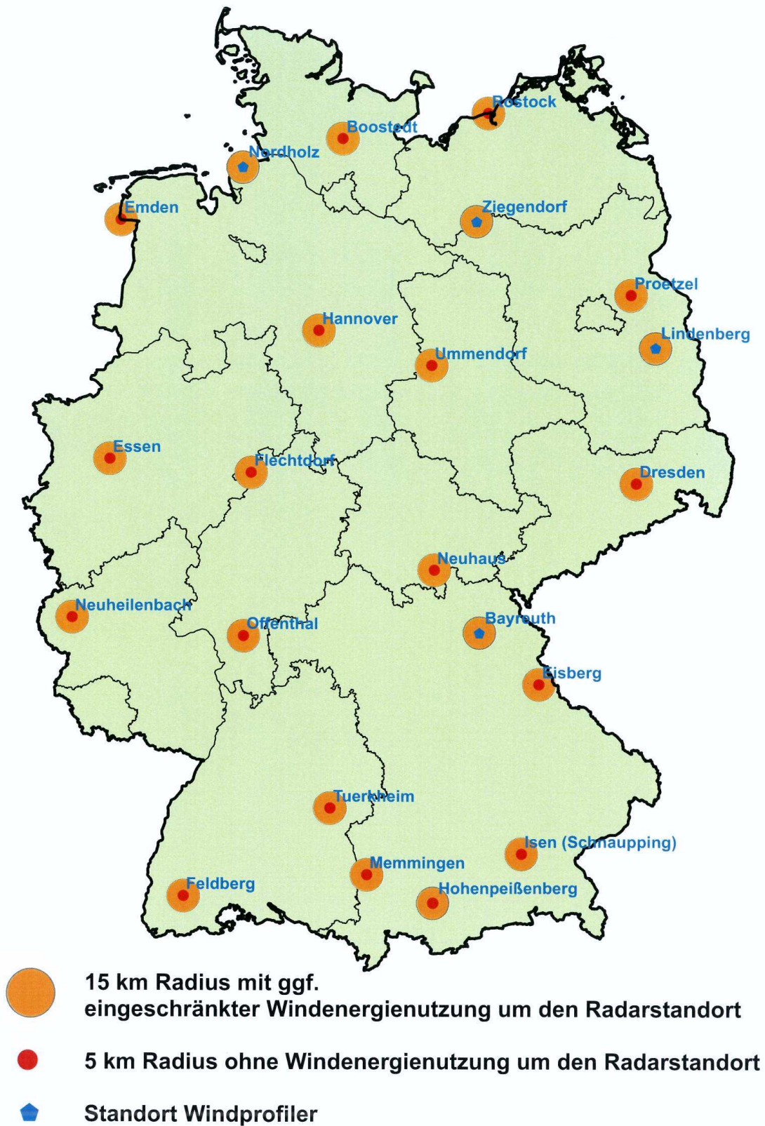
Abbildung 1: Wetterradar- und Windprofilerstandorte des DWD
